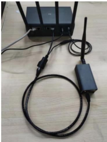
图中示例使用路由器USB接口的5V电源，通过POE合路器和网线给WH126供电。
